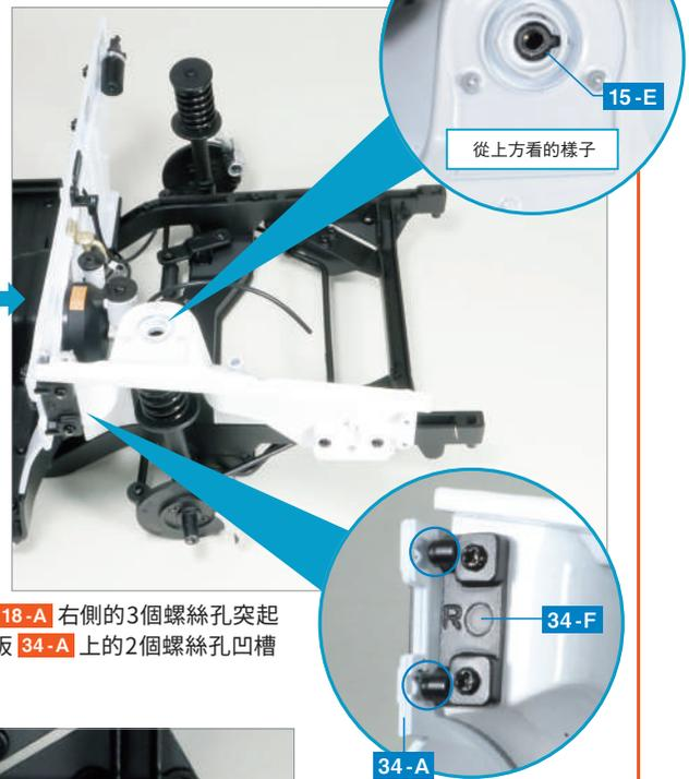
接下來，將 36-A 的下側插入麥花臣懸吊系統和煞車主缸 35-I 之間，並將前副車架 18-A 右側的3個螺絲孔突起部分與 36-A 的凹槽對齊組裝。此外，將 34-F 的2個螺絲孔突起部分嵌入艙壁隔板 34-A 上的2個螺絲孔凹槽中。
