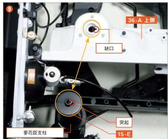
首先，將右側的麥花臣支柱整體旋轉，使支柱上座 (R) 15-E 的突起部分對準 36-A 的缺口方向。
