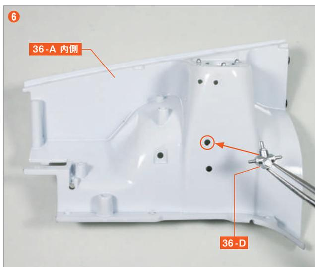
將 36-A 翻至正面，將前輪煞車管連接器 36-D 的突起部分嵌入內側的洞孔中。
