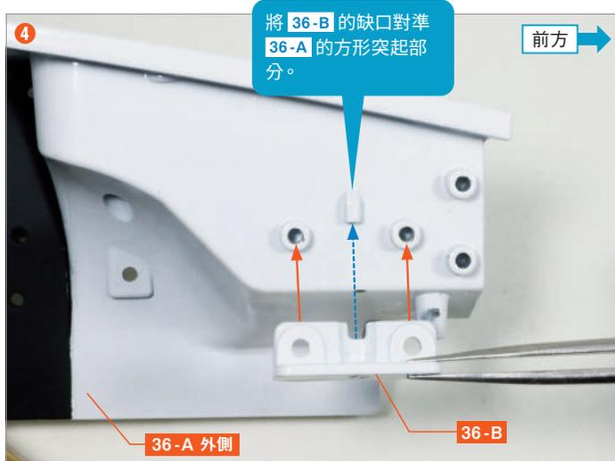
將前擋泥板支架 (R) 36-B 的背面凹槽對準 36-A 外側前方螺絲孔的突起部分，並嵌入。
