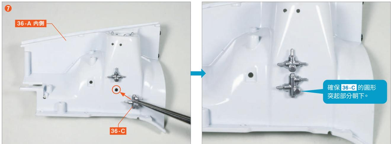
將比例閥 36-C 的突起部分嵌入 36-A 內側的洞孔中。
