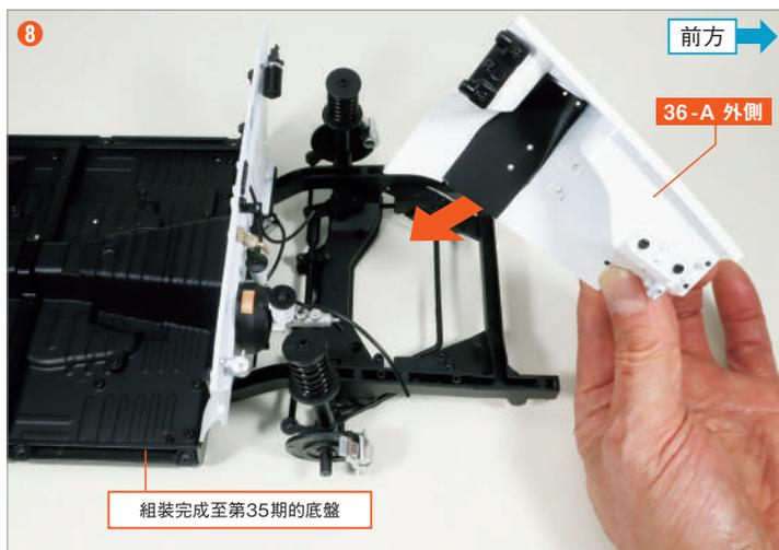
備妥組裝到第35期的底盤，將 step 1 組裝好的右側前翼擋泥板安裝到艙壁隔板前的右側。
