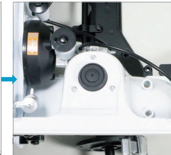
將前輪煞車管連接器 36-E 的背面凹槽對準 36-A 的 AJM螺絲 周圍的突起部分，然後插入。
