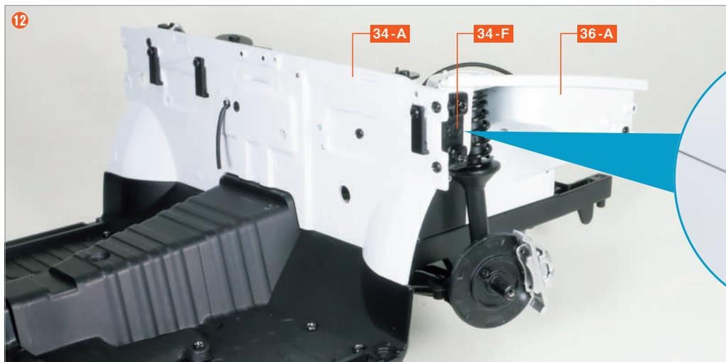
將 34-F 的螺絲孔突起部分與 34-A 的螺絲孔凹槽對齊，然後使用第34期中保管的 CM 螺絲 固定兩個位置。
